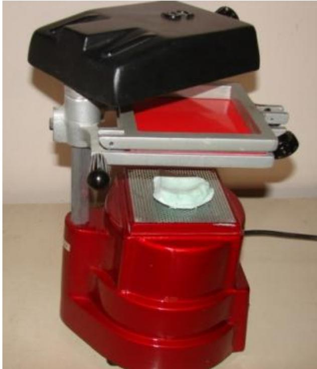
**Fig. 13.** Termoformadora con lámina y modelo ubicado en la base.
