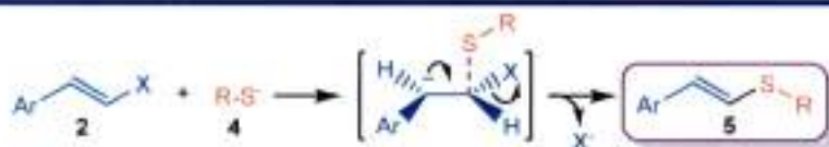
Esquema 2.19 Mecanismo de adición-eliminación en pasos para la S_NV en la formación de sulfuros vinílicos.
