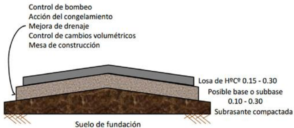
Figura 3.5: Perfil transversal de la conformación del paquete estructural.
