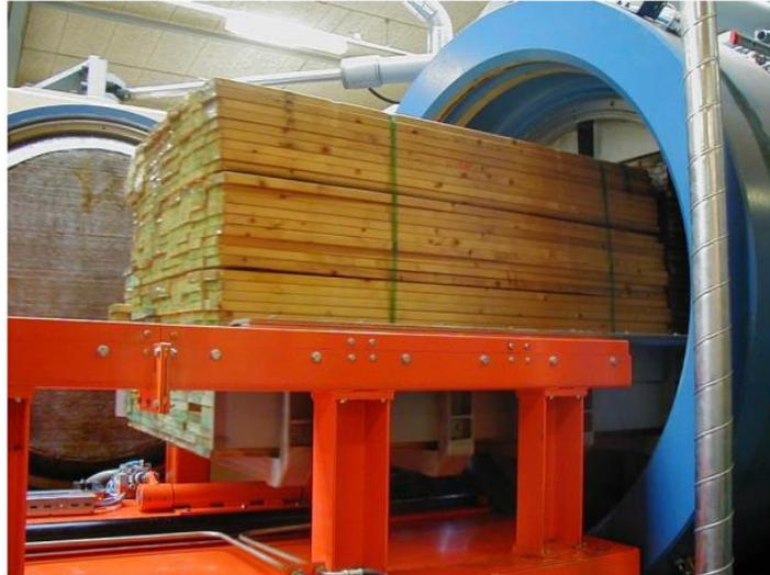
**Figura 7.2.** Impregnación supercrítica de madera a escala industrial.
