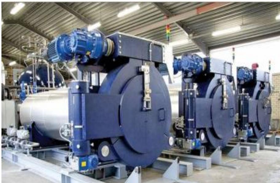
**Figura 7.1.** Equipo industrial supercrítico para el teñido de telas
