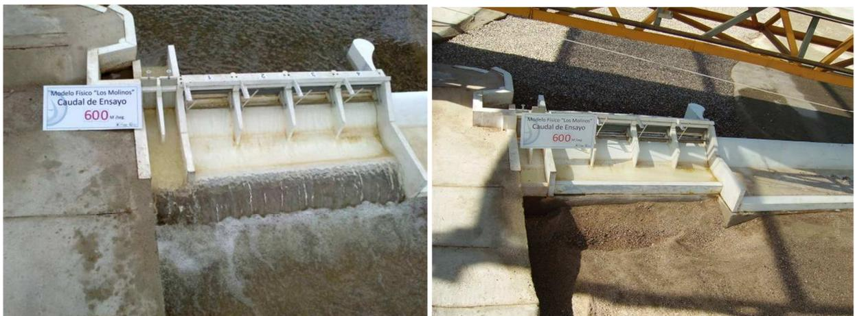
Figura 6. Ensayo  $600 \text{ m}^3/\text{s}$ ; a) Ensayo hidráulico; b) Cuenco resultante.
