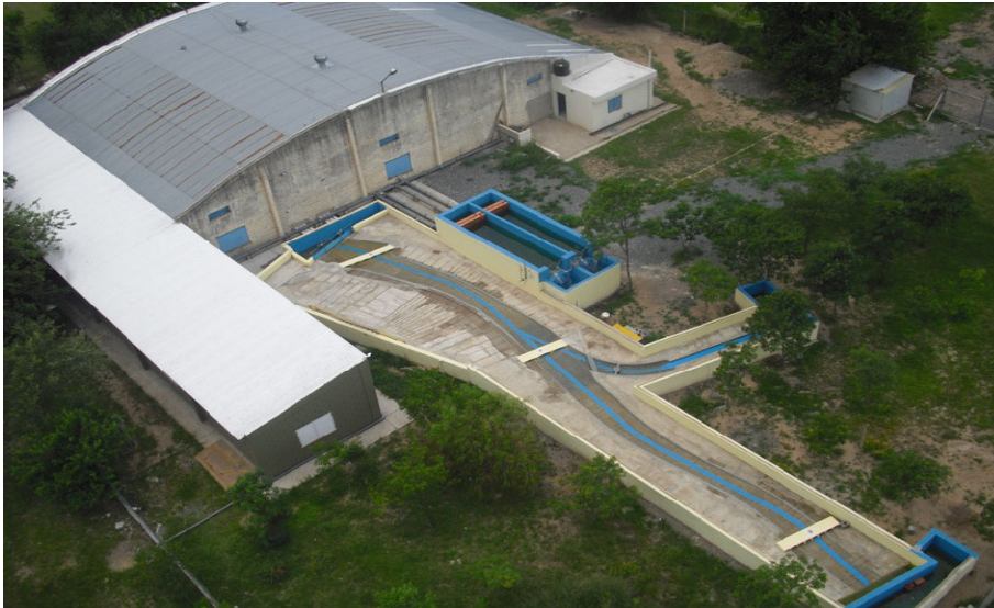
Figura 3.- Modelo físico confluencia Río Suquía – Arroyo La Cañada.
