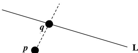
El punto de la recta  $L$  más próximo del punto  $p$  es el punto  $q$ , pie de la perpendicular a  $L$  trazada por  $p$ .
