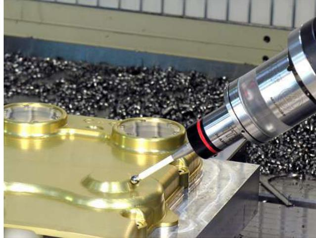
Fig. 1.3 - Sistema de medición a bordo de máquina
