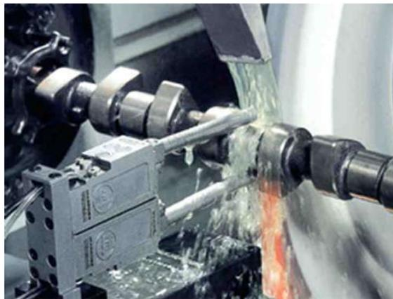
Fig. 1.2 - Sistema de medición *in-process*
