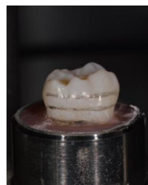
Figura 1C. Inclusión en los tubos fijados acrílico autopolimizable.
