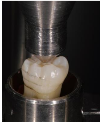
Figura 3D. Vástago posicionado en fosa central.
