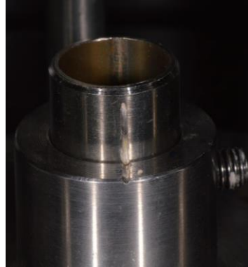
Figura 3B. Tubo de fijación y el aditamento para ajustar su posición.
