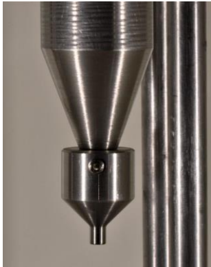
Figura 5A. Accesorio de extremo plano de 4,1mm de diámetro montado.
