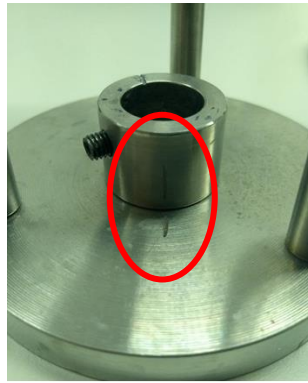
Figura 2B. Pieza de fijación para las muestras con marcas.
