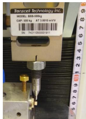
Figura 30B. Punta fijada al brazo de la máquina de ensayos.
