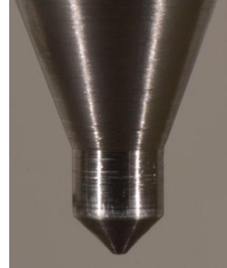
Figura 3C. Extremo cónico del vástago.
