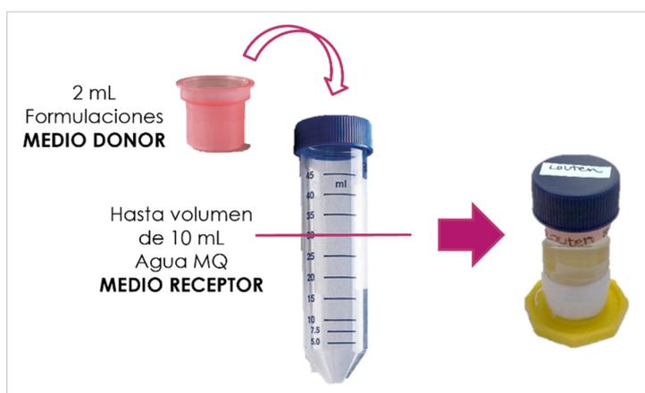
**Figura 2.5.** Adaptación de dispositivos de diálisis para ensayos de liberación *in vitro*.
