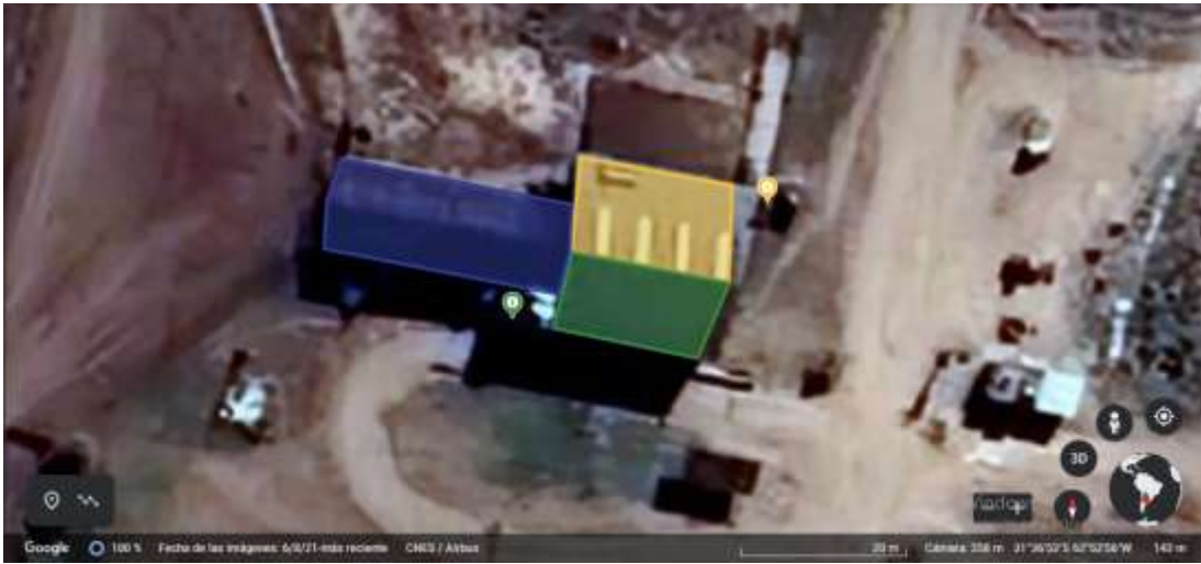
Figura 6. Techos del tambo. Polígono azul: Media sombra, corral de espera (320 m 2 ); Polígono amarillo: Chapa, ala Norte del tambo (220 m 2 ); Polígono verde: Chapa, ala Sur del tambo (200 m 2 ); Marcador amarillo: Tanque de almacenamiento de agua pluvial; Marcador verde: Tanque de almacenamiento de agua para la limpieza de los pisos.
