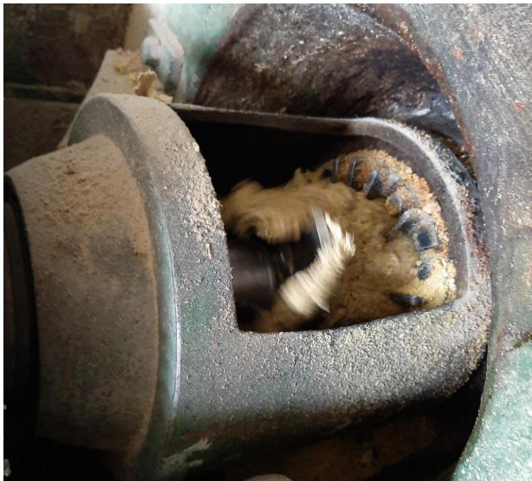
Figura 17: Expeller saliendo de la prensa.
