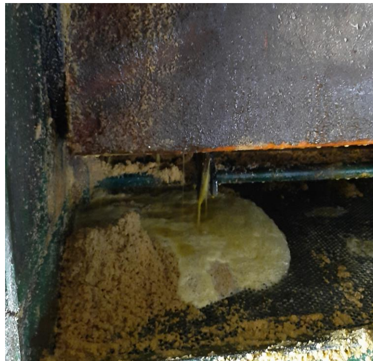
Figura 18: Aceite y sólidos saliendo de la prensa.
