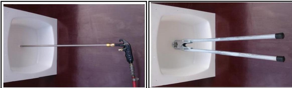
*Fig. 39 y Fig. 40. Herramientas de desmolde. A la izquierda, la herramienta neumática para incorporación de aire comprimido. A la derecha, la "pinza tuerca", para remoción de los casetones.*
