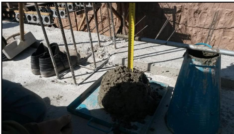
*Fig. 38 . Ensayo Cono de Abrams. 15 cm de asentamiento.*
