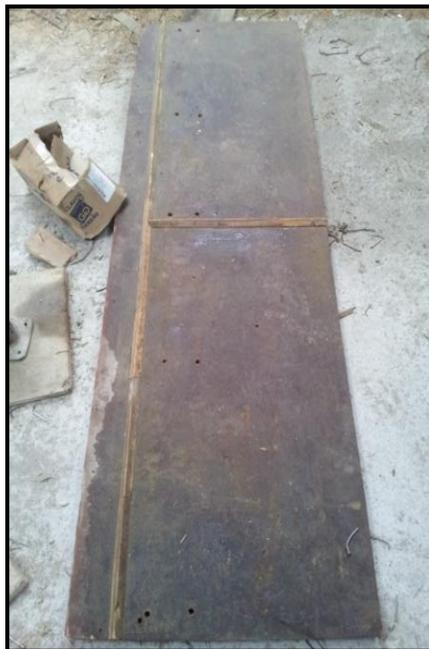
*Fig. 25. Detalle de tablillas sobre fenólicos para lograr hendiduras sobre Hormigón.*
