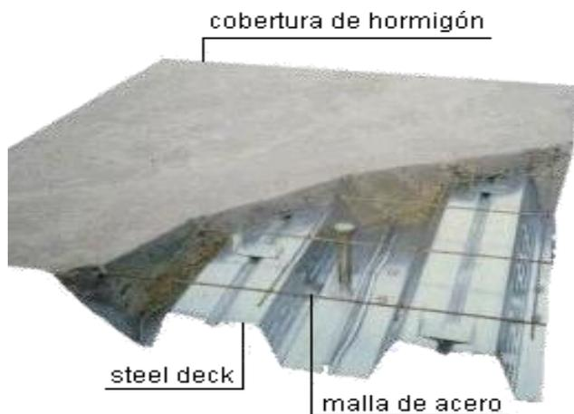
Suprime a los casetones y a los tableros utilizados hasta ahora en la elaboración de los entrepisos y losas, mejorando la capacidad estructural de los mismos y disminuyendo la cantidad de hierro y hormigón requeridos.
