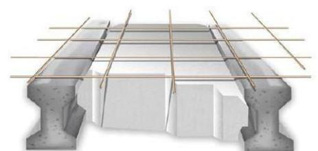
Bloque de poliestireno sostenido por dos viguetas pretensadas.
