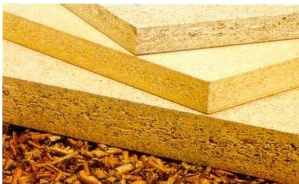
Los aglomerados que se emplean frecuentemente para revestir las superficies interiores de los encofrados se fabrican a base de pequeños trozos de madera impregnados en resinas sintéticas, polimerizándose a continuación por cocción. Los tableros se suelen comercializar en grandes piezas, las ventajas son:
