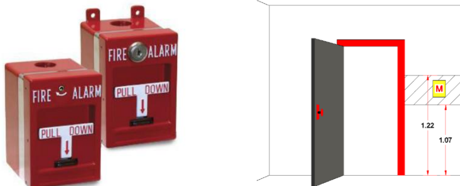
Imagen 6.1.2 Iniciadores Manuales de doble acción, una vez accionada solo se desactivará con la llave correspondiente. Y su correcta ubicación según NFPA 72 – Capítulo 17.14.5.
