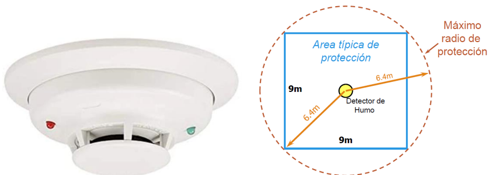
Imagen 6.1.3 Modelo de detector de humo fotoeléctrico y área máxima de protección.
