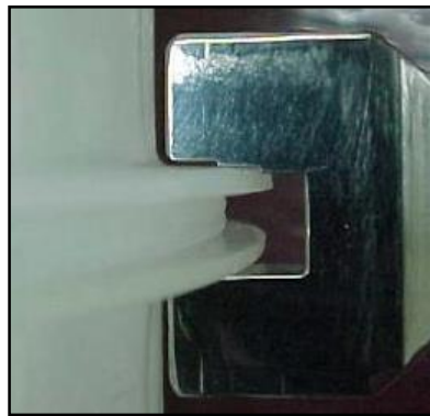
Figura 3-11 Medición de espesor de soldadura con calibre
