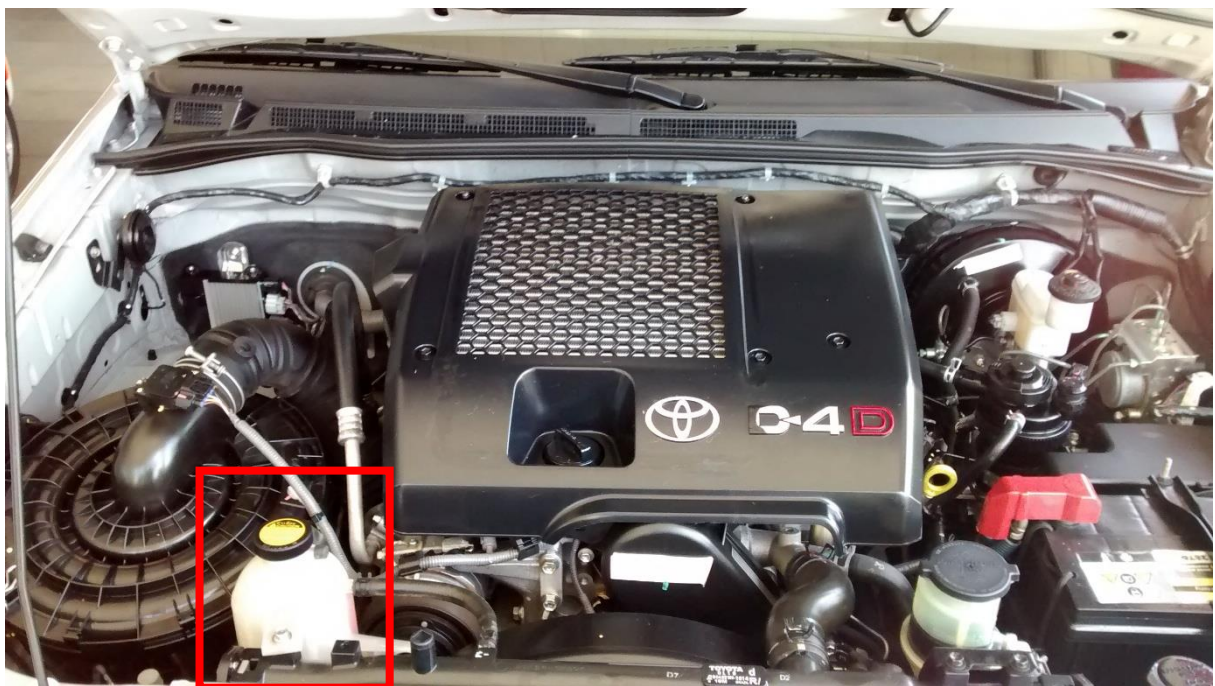
Figura 2-4 Localización del Reservorio de Agua actual
