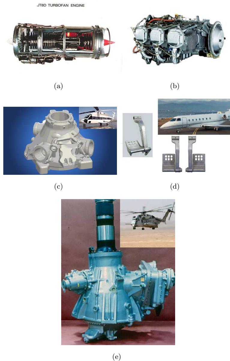
FIGURA 2.3: a) Caja de accesorios del motor turbofan JT8D [21]. b) Carter del motor Lycoming 540 [22]. c) Helicóptero Sikorsky S-92, caja reductora [23]. d) Pedales de comando [24]. e) Helicóptero Sikorsky CH-53 Sea Stallion, caja reductora [25].
