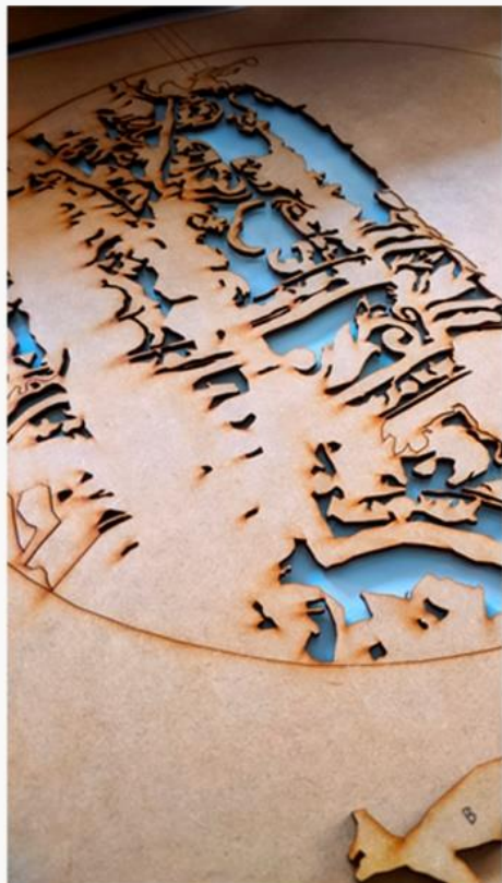
Matriz cortada con tecnología láser , antes del entintado.
