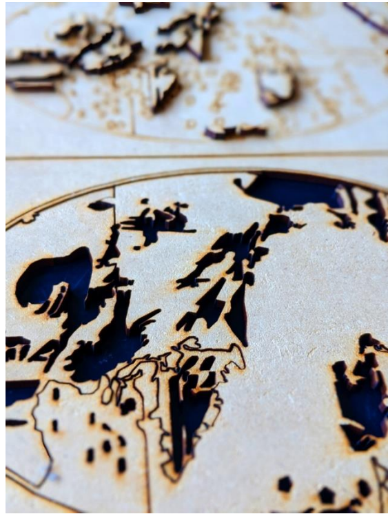
Piezas cortadas con tecnología láser. (Escala variable)
