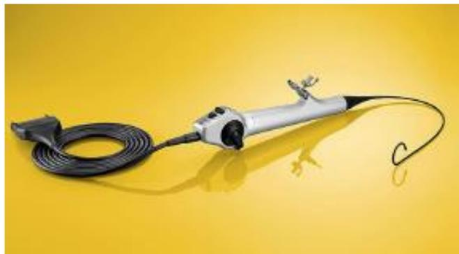
**Figura 1.7.** Foto endoscopio flexible para neuro-endoscopia. Se utiliza para neurocirugía intracraneal. Diámetro reducido exterior de 2,8 mm con canal de trabajo integrado de 1,2 mm. Permite realizar acodamiento progresivo de 270° hacia arriba y hacia abajo para una orientación intuitiva y una representación total del sistema ventricular.
