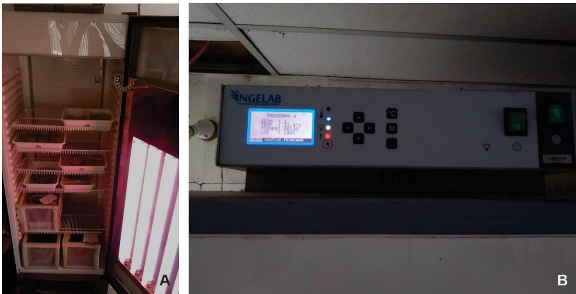
Figura 8. A) cámara de cría. B) Configuración de temperatura, humedad y fotoperiodo de las cámaras de cría.
