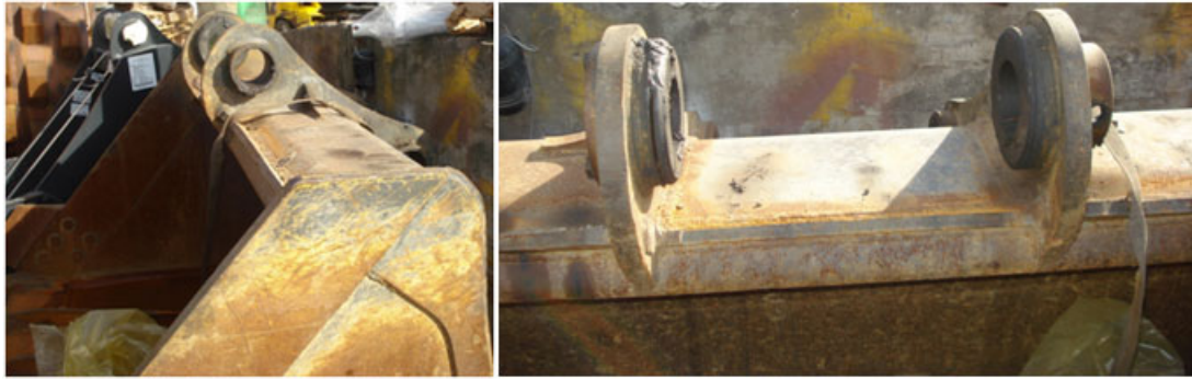
Figura 7.4: Detalle anclajes de balde
