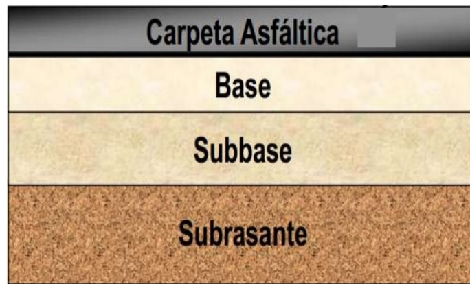
Figura 1.1: Capas de un pavimento asfáltico
