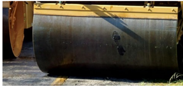
Figura 7.18: Tambor de rodillo vibratorio con asfalto adherido
