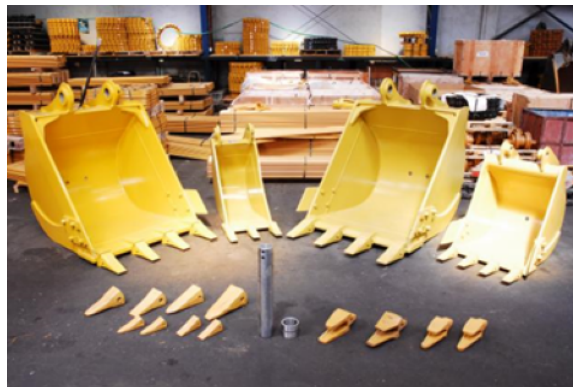
Figura 1.10: Baldes de excavadora y algunos elementos de desgaste
