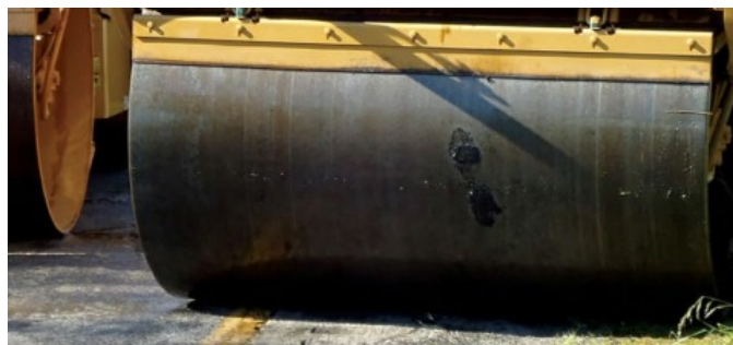
Figura 7.8: Fragmento de asfalto adherido a tambor de RV
