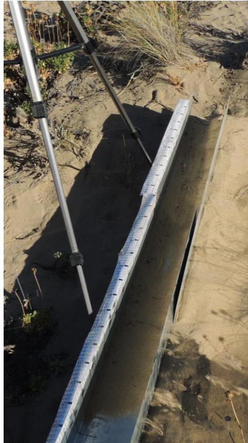
Figura 10: Dispositivo utilizado para medir la velocidad de carrera.
