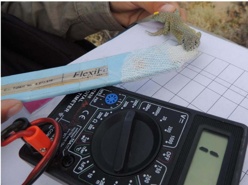
Figura 11: Sensor FlexiForce unido a un multímetro para registrar la fuerza de mordida.
