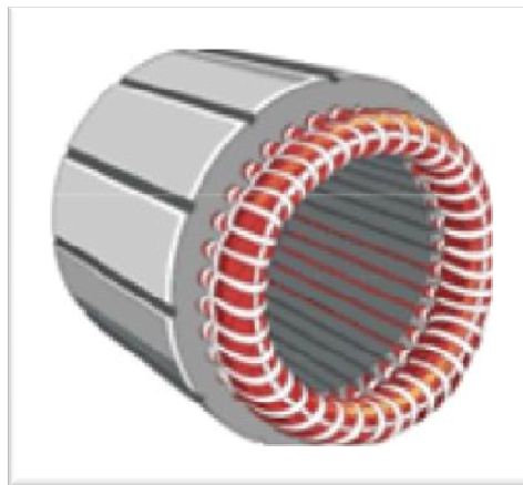
Figura 3.1 – Estator o circuito inductor.
