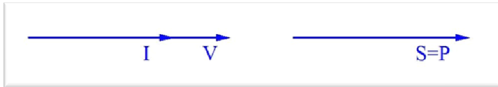
Figura 2.4-a - Corriente y Potencia en una carga resistiva pura.
