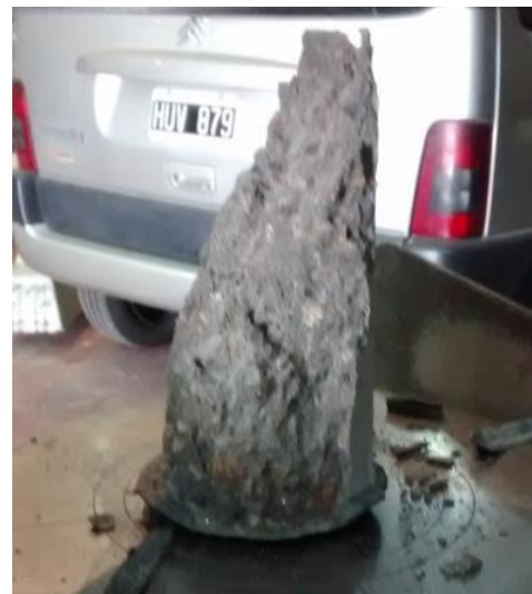
Figura 9.10: Rotura de probeta por compresión simple.
