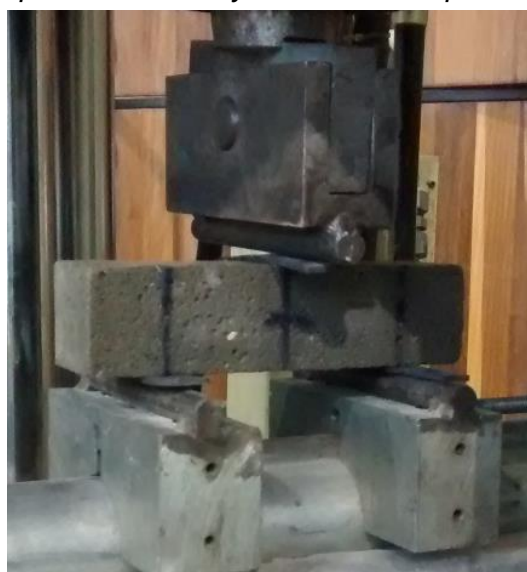
Figura 8.3: Dispositivo de ensayo de flexión en probetas prismáticas.
