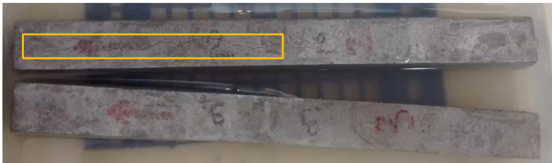
Figura 9.22: Reacción álcali – agregado. Pastón B.
