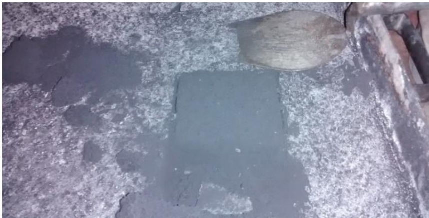
Figura 7.9: Formación y remoción de costra salina en la superficie de cenizas apagadas con agua destilada.
