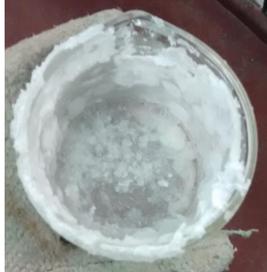
Figura 7.11: Sales solubles de cenizas apagadas, sin costra.
