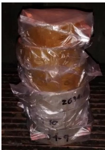
Figura 9.11: Discos de hormigón preparados para el ensayo de succión capilar.
