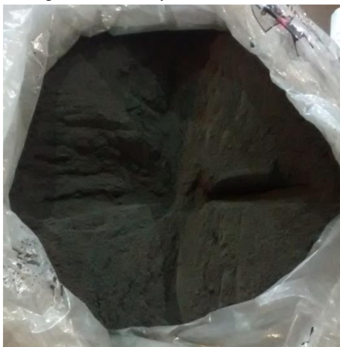
Figura 7.3: Mezcla y cuarteo de Muestra B.
