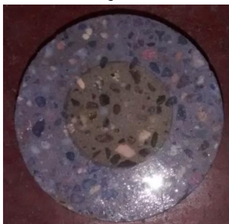
Figura 9.15: Probetas de hormigón preparados para el ensayo de penetración de agua.
