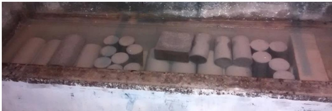
Figura 9.5: Probetas en piletas de curado.
