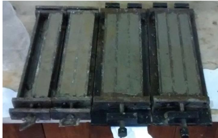
Figura 9.17: Moldeo de probetas para ensayo de RAS.
