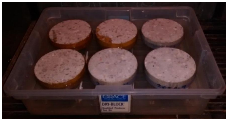
Figura 9.12 Dispositivo de ensayo de succión capilar.
