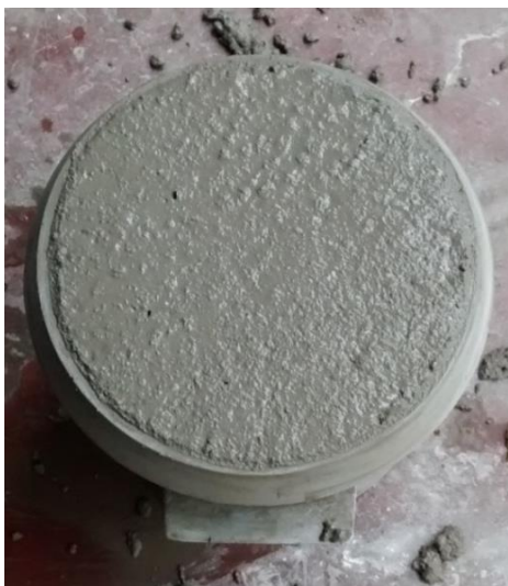
Figura 9.7: Determinación de la densidad en estado fresco.
