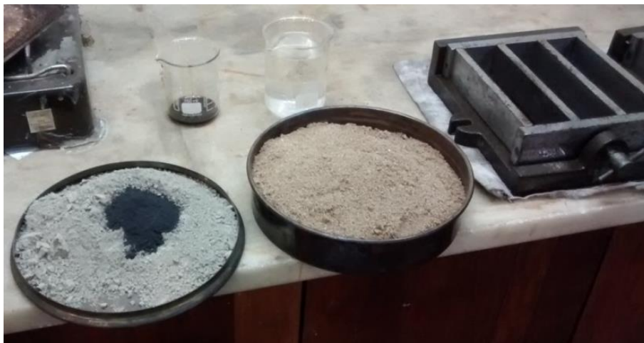
Figura 8.1: Preparación de moldes y pesado de materiales.
