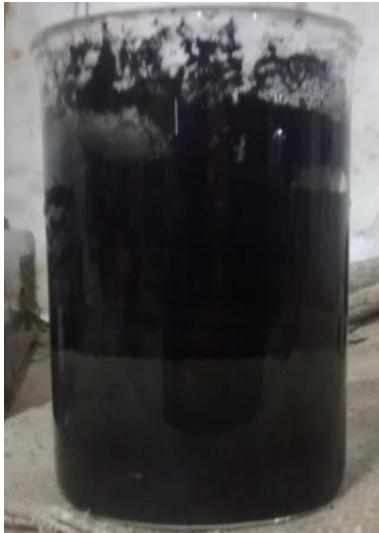
Figura 7.7 Ensayo de sales solubles sobre cenizas en estado natural.
