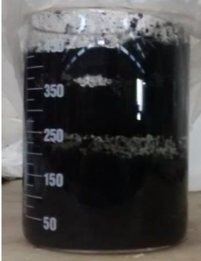
Figura 7.10: Ensayo de sales solubles sobre cenizas apagadas, sin costra.
