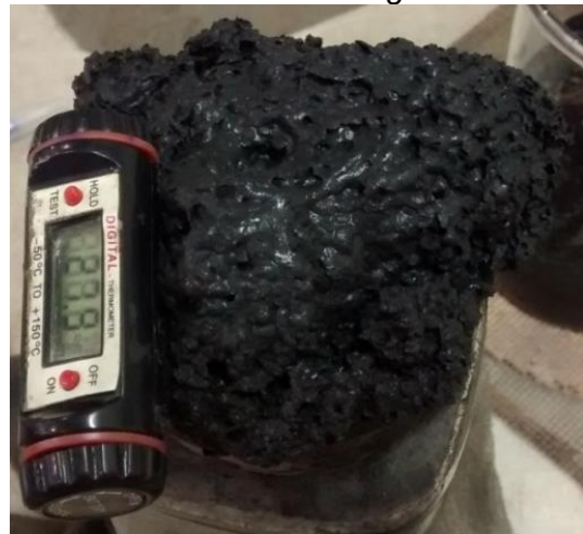
Figura 7.14: Aspecto de las cenizas al reaccionar con agua.
