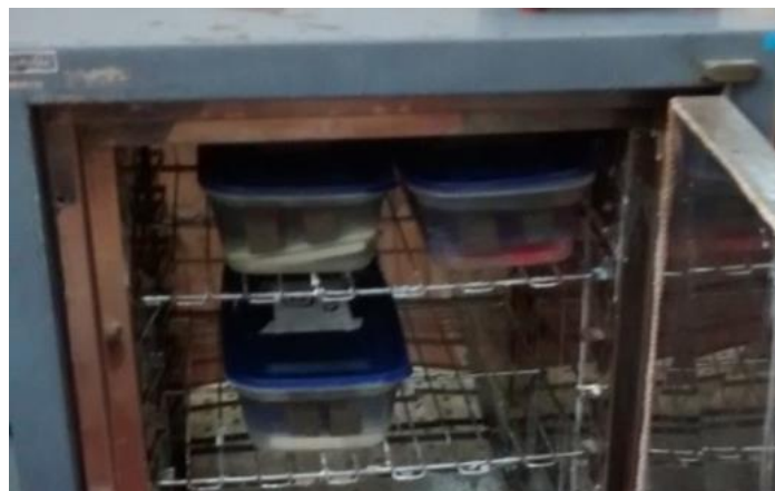
Figura 9.18: Ensayo de RAS.
