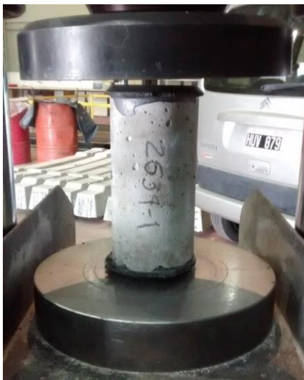
Figura 9.9: Probeta encabezada y colocada en la prensa.
