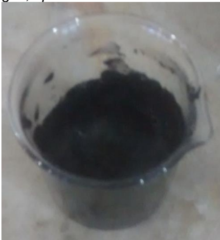
Figura 7.13: Mezcla de cenizas con agua, apenas finalizado el mezclado.
