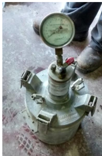
Figura 9.8: Medición del contenido de aire.
