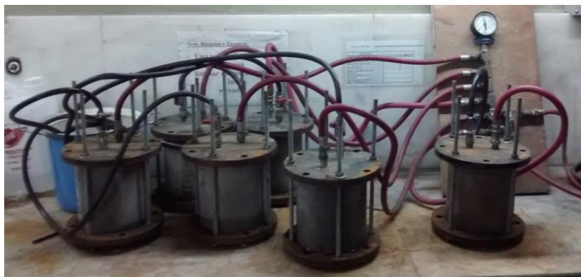
Figura 9.16: Dispositivo de ensayo de penetración de agua.
