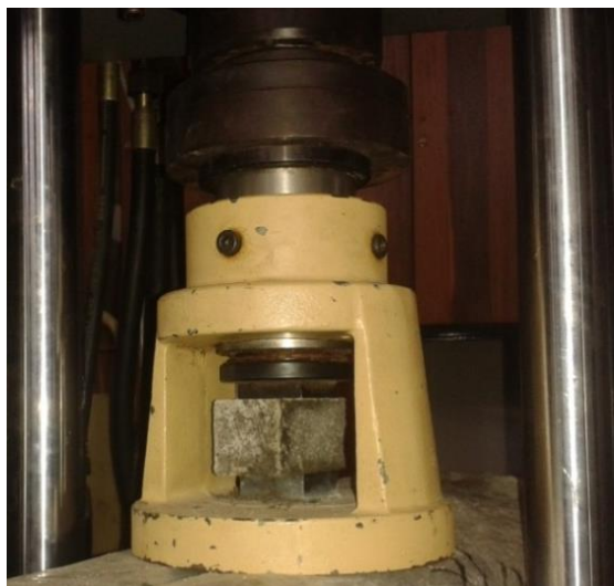
Figura 8.4: Dispositivo de ensayo de compresión en probetas prismáticas.
