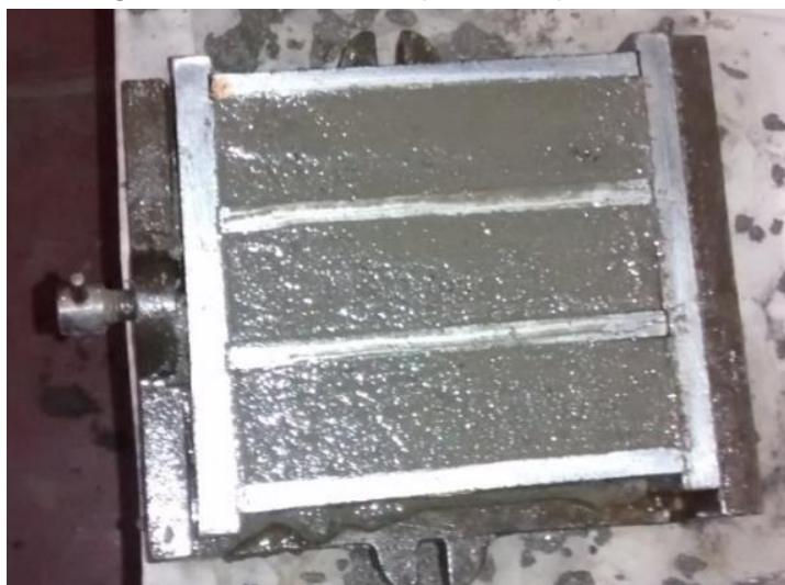
Figura 8.2: Llenado de probetas prismáticas
