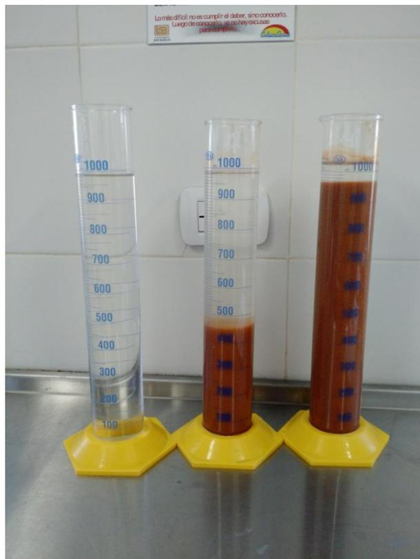
Figura 20. Comienzo del proceso de sedimentación (derecha). Fin de proceso con sólidos decantados (centro). Líquido clarificado que va al tanque australiano (izquierda).
