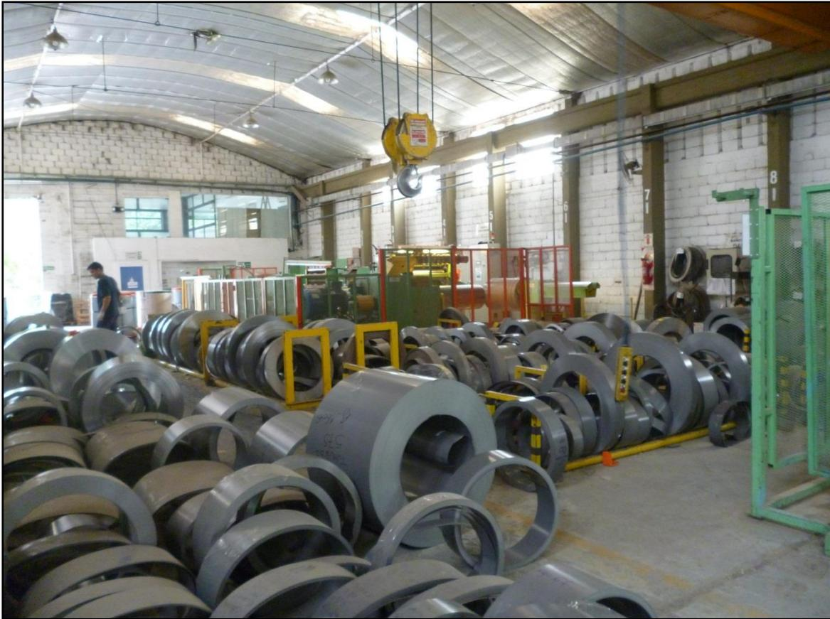
**15. Layout de material y herramientas:** como se observa en las fotografías anteriores hay una demarcación vieja y deteriorada que no es respetada para el material y herramientas.
