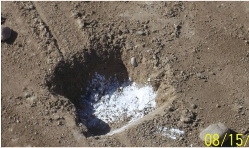
Fig. N° 57-7 control del espesor de la capa
