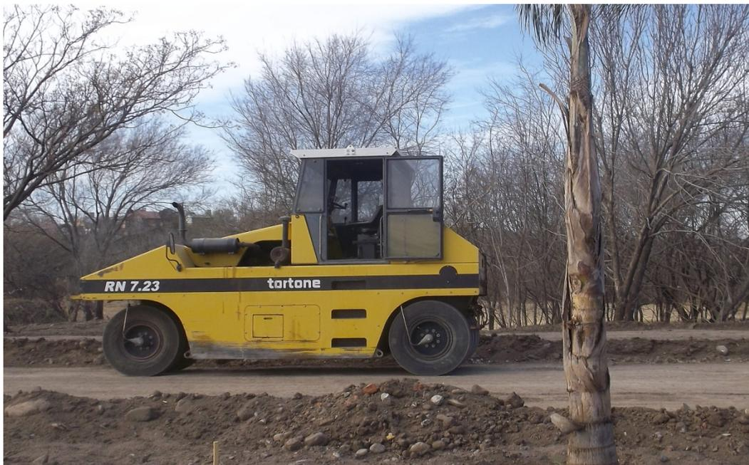
Fig. N° 63-7 Compactador neumático
