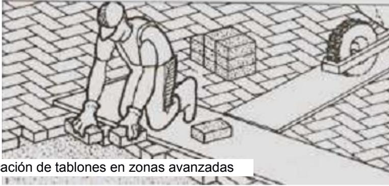
Fig. N° 106-8 Colocación de tablonces en zonas avanzadas
