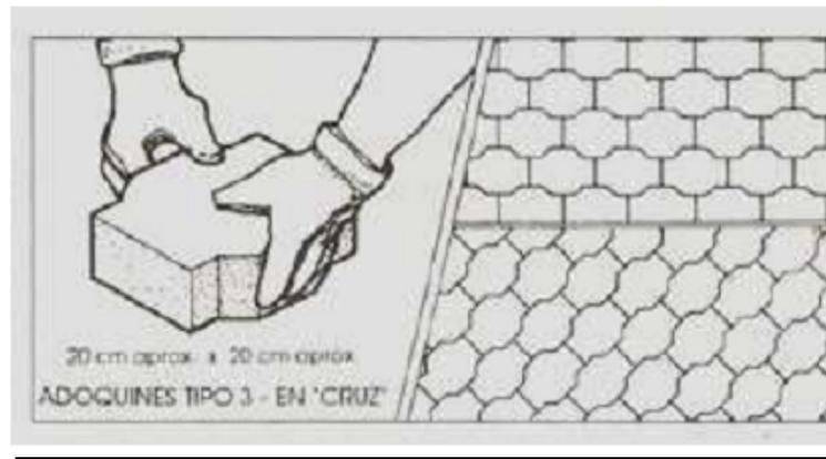
Fig. N° 81-8 forma de colocación de adoquines tipo 3
