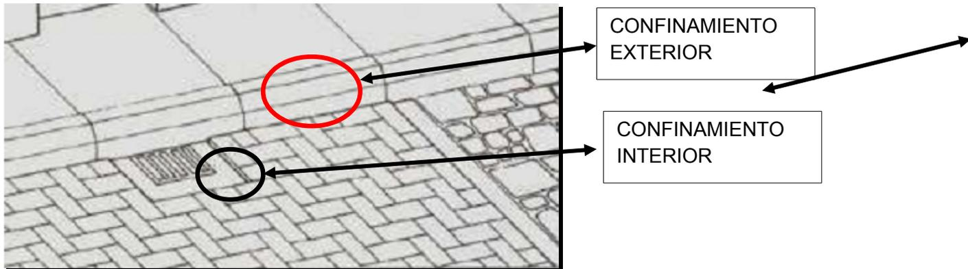
Fig. N° 87-8 Estructuras de confinamiento
