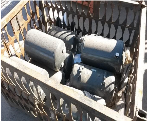
Fig 4.6- Tanques de aire a la intemperie.
