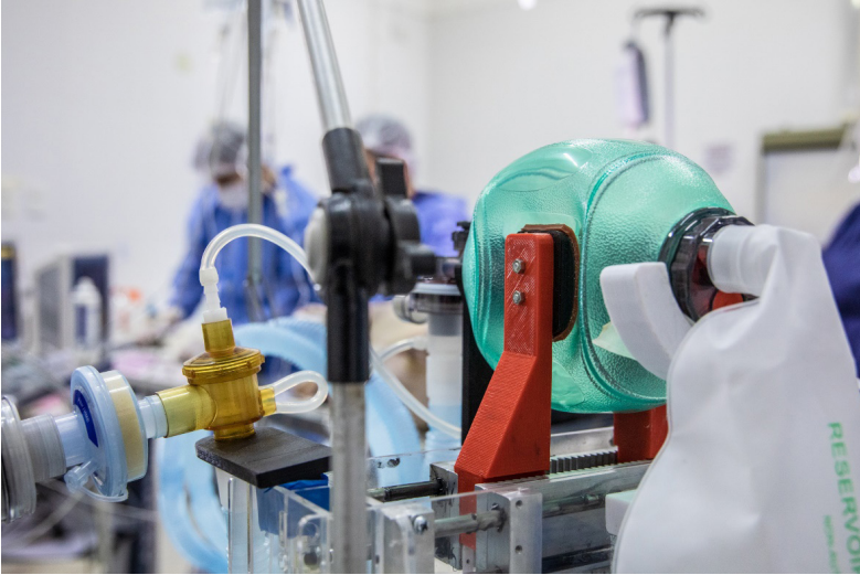
Testeo de prototipo de respirador. Fuente: DIRCOM-UNL
