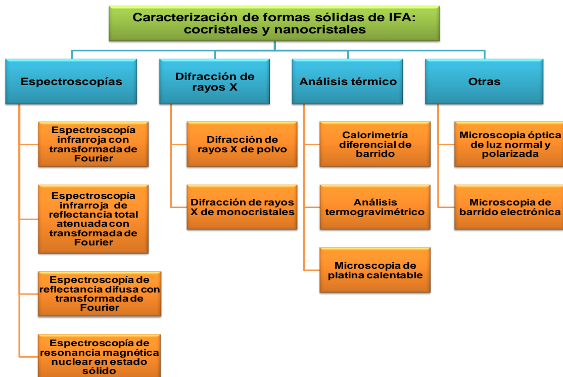
Figura 2.1. Algunas de las técnicas analíticas utilizadas para la caracterización de formas sólidas de los IFA (Adaptada de Healy et al. , 2017).
