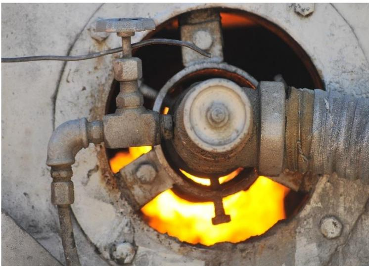
*Ilustración 8: Método de calentamiento de pintura termoplástica*
