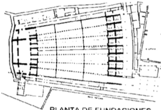
PLANTA DE FUNDACIONES Se pueden reconocer los cables (línea clara) y los tabiques longitudinales (línea llena) de H° A°. Los primeros están enlazados, por el trono, a una estructura en caja de H° A° que alberga algunos espacios, y por el otro lado, a los pilares del atrio. Los tabiques cumplen la tarea de sostener la sobrecarga del pavimento de la sala y se sustentan sobre una platea general de H° A°.
