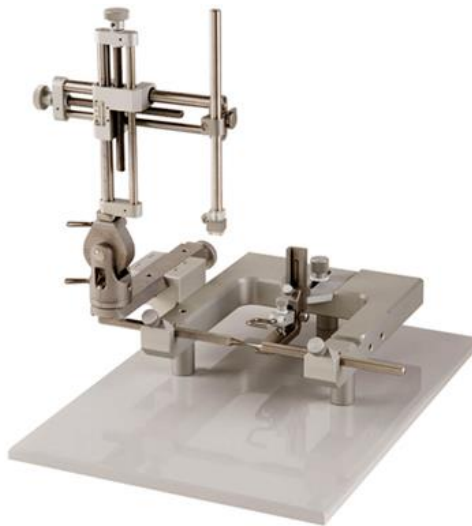
Figura 4. Estereotáxico Stoelting. Este aparato permite inmovilizar al animal anestesiado y registrar las coordenadas necesarias para ubicar puntos de referencia en el cráneo y para alcanzar con exactitud las áreas cerebrales de interés mediante la correcta implantación de cánulas. Más detalles en el texto.
