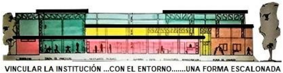
Fig.4. Escalonamiento de la forma del edificio para establecer jerarquías en las áreas del programa.
