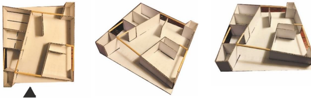
Fig. 42, 43 y 44. Estudio de la estructura, maqueta Esc: 1:100. Un esquema portante mixto de cajas en tabiquería, se combina con elementos filares aperticados de hormigón armado para soportar la cubierta unificadora.
