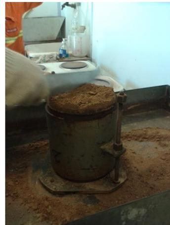
**Figura 3.78:** Enrasado de la probeta
