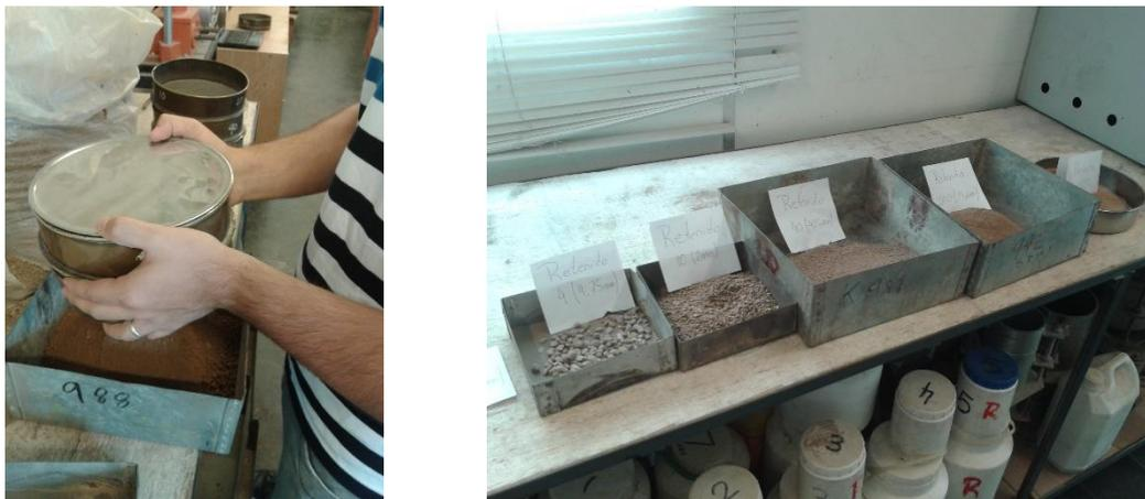
Figura 3.88: Tamizado y muestras divididas según retenido de la serie utilizada.
