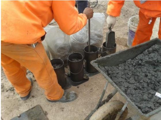
**Figura 3.98:** Llenado de probetas.
