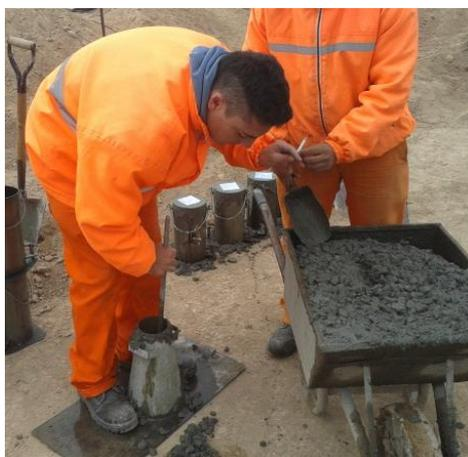
**Figura 3.95:** Ejecución del ensayo de asentamiento.
