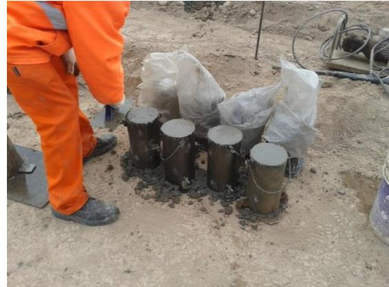
**Figura 3.99:** Enrasado de probetas.
