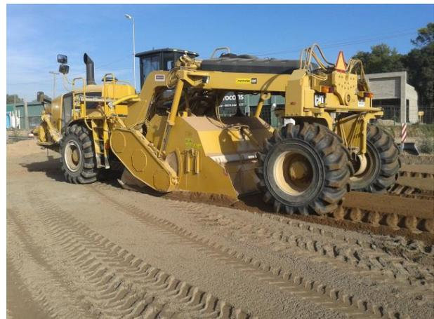
**Figura 3.14:** Reciclado en cancha de mezclado.
