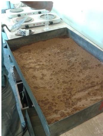
**Figura 3.77:** Agregado de agua para llevar la muestra a la humedad óptima.
