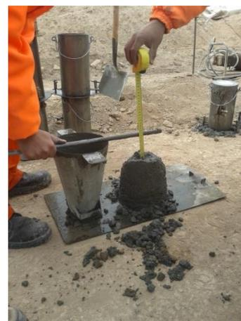
**Figura 3.96:** Medición del asentamiento.
