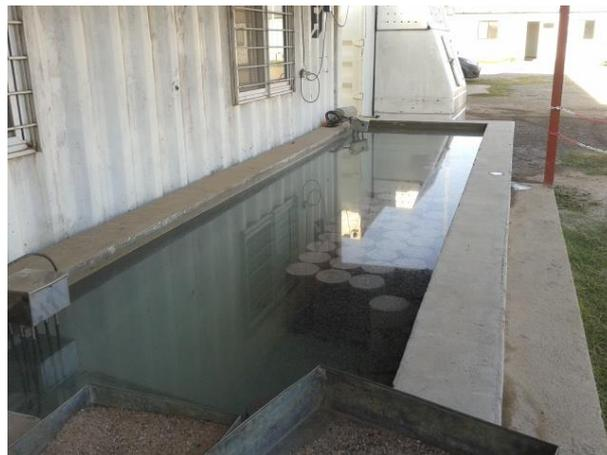
**Figura 3.102:** Cámara de curado de probetas.
