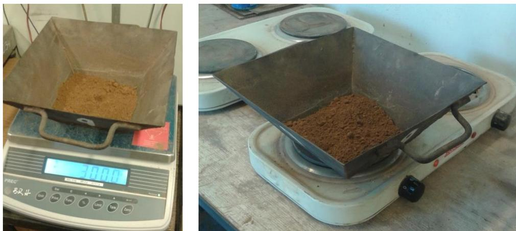
**Figura 3.67:** Pesado y secado del material para determinación de humedad.
