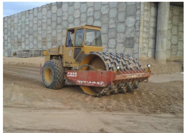
**Figura 3.21:** Compactador de cilindro metálico con tacos y dos ruedas de goma.
