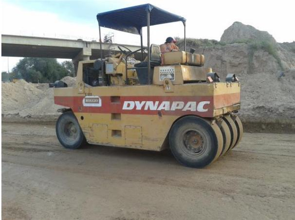
**Figura 3.22:** Rodillo neumático liso
