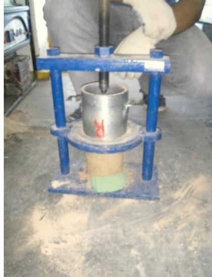
**Figura 3.74:** Desmolde de probetas.
