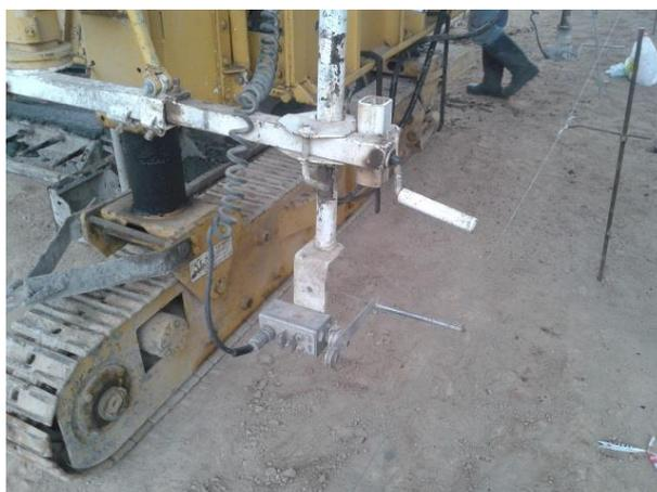
**Figura 3.28:** Vista sensor del tren de la pavimentadora sobre hilo guía.
