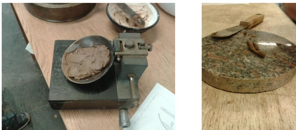
**Figura 3.89:** Ejecución del ensayo para determinar el índice de plasticidad.
