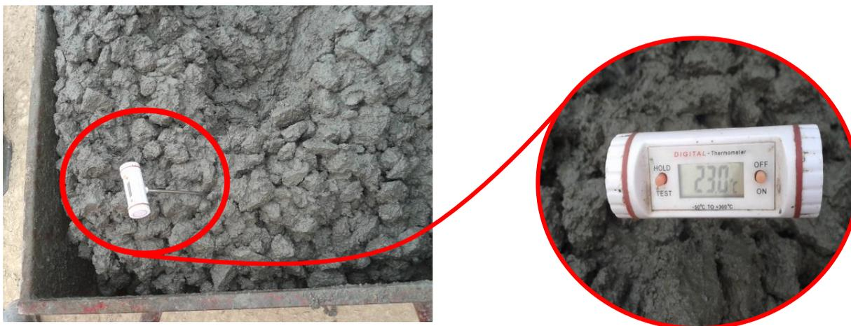
**Figura 3.97:** Control de la temperatura del hormigón.
