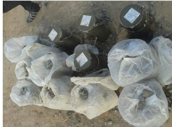
**Figura 3.101:** Protección de probetas para posterior curado.
