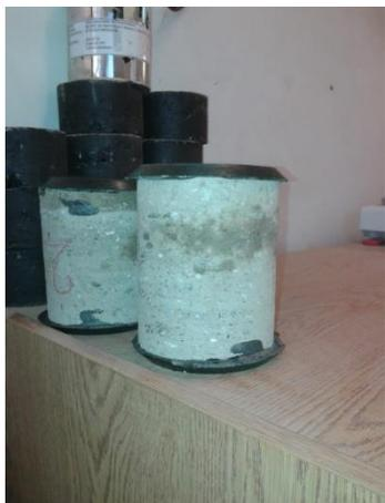
Figura 3.92: Testigos encabezados.
