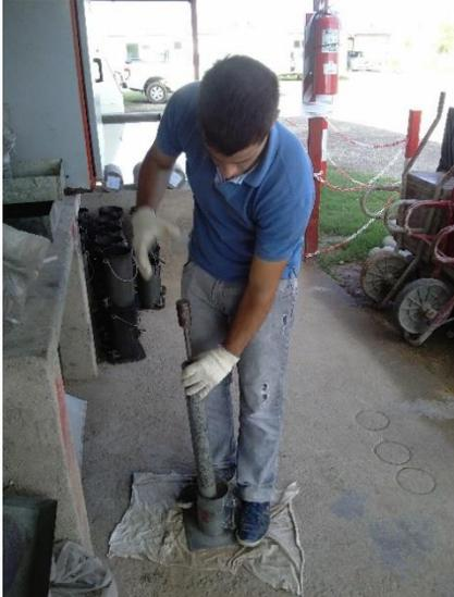
**Figura 3.73:** Compactación de la probeta.
