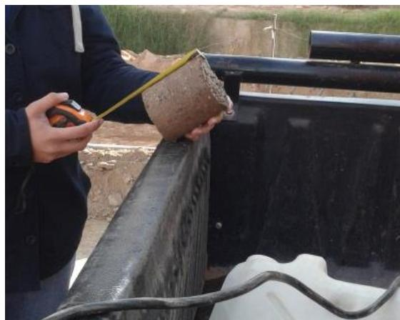
**Figura 3.91:** Medición de la altura del testigo.
