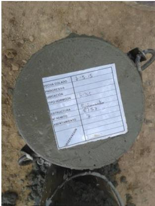
**Figura 3.100:** Etiquetado de las probetas.
