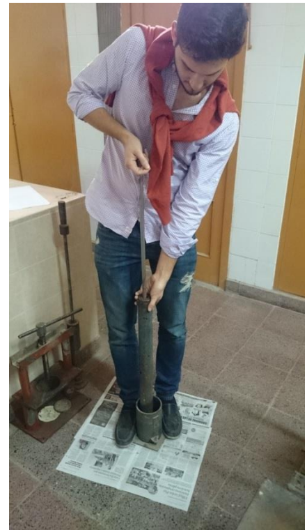
Figura 30: Ensayo de compactación
