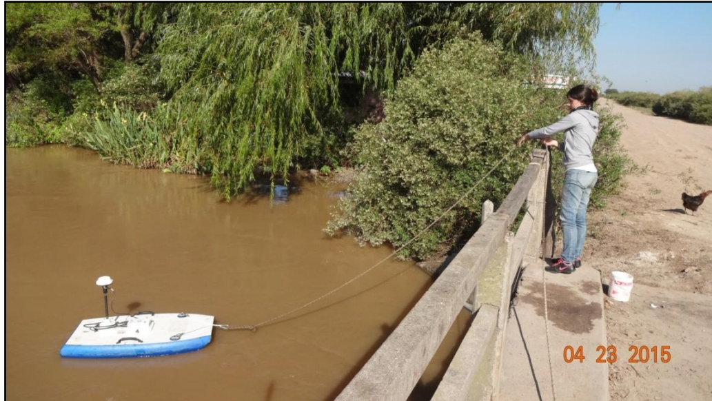
Figura 70. Aforo sección Paso de la Cina
