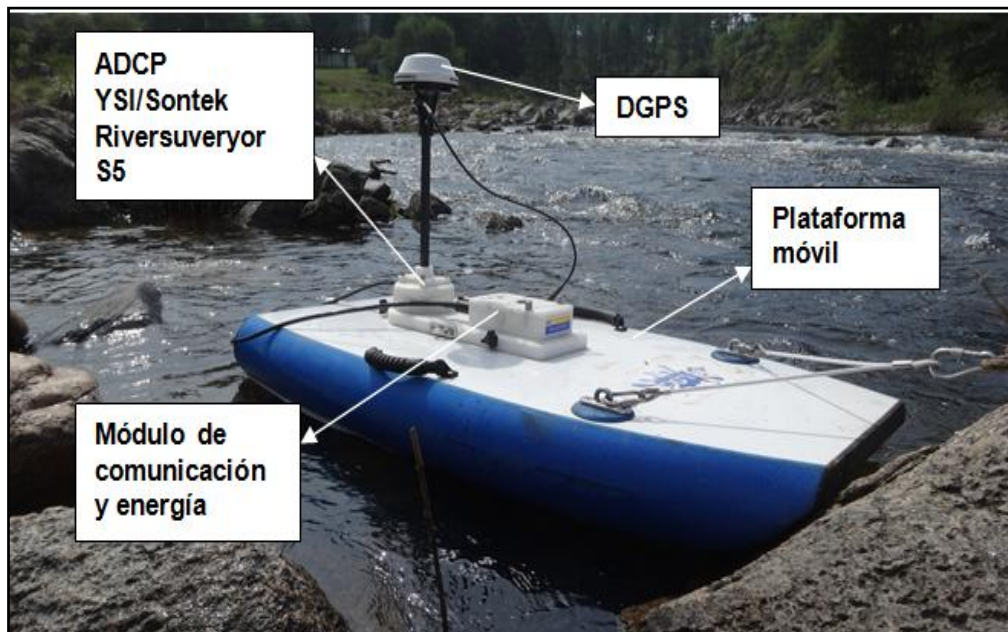
Figura 60. ADCP y demás dispositivos montados en la plataforma móvil de medición
