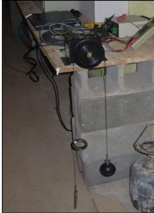
Figura 57. Sensor de nivel Waterlog H-334.
