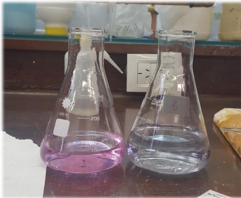
Figura 2. Viraje de color en la titulación de Dureza, con el rojo vino a la izquierda y azul a la derecha.
