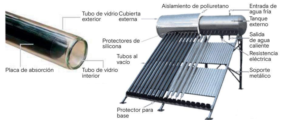
Figura 21. Colector solar de tubos de vidrio al vacío.
