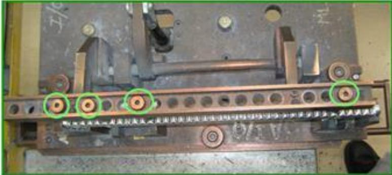
**POSICIÓN CORRECTA DE LOS RESORTES. ASEGURARSE DE COLOCAR LOS RESORTES EN ÉSTOS AGUJEROS PARA MODELO 5A**
