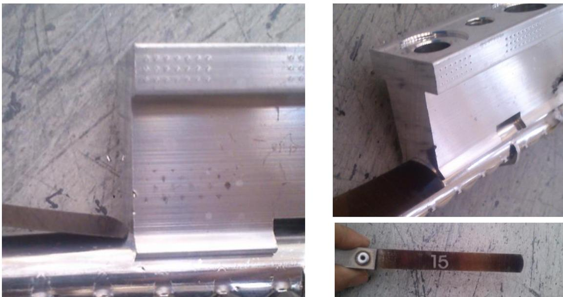
Figura 63: Distancia entre racor y tubo distribuidor luego de contramedida.
