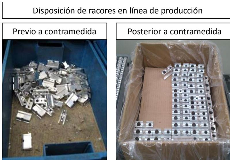
Figura 64: Abastecimiento a línea de racores en embalaje original.
