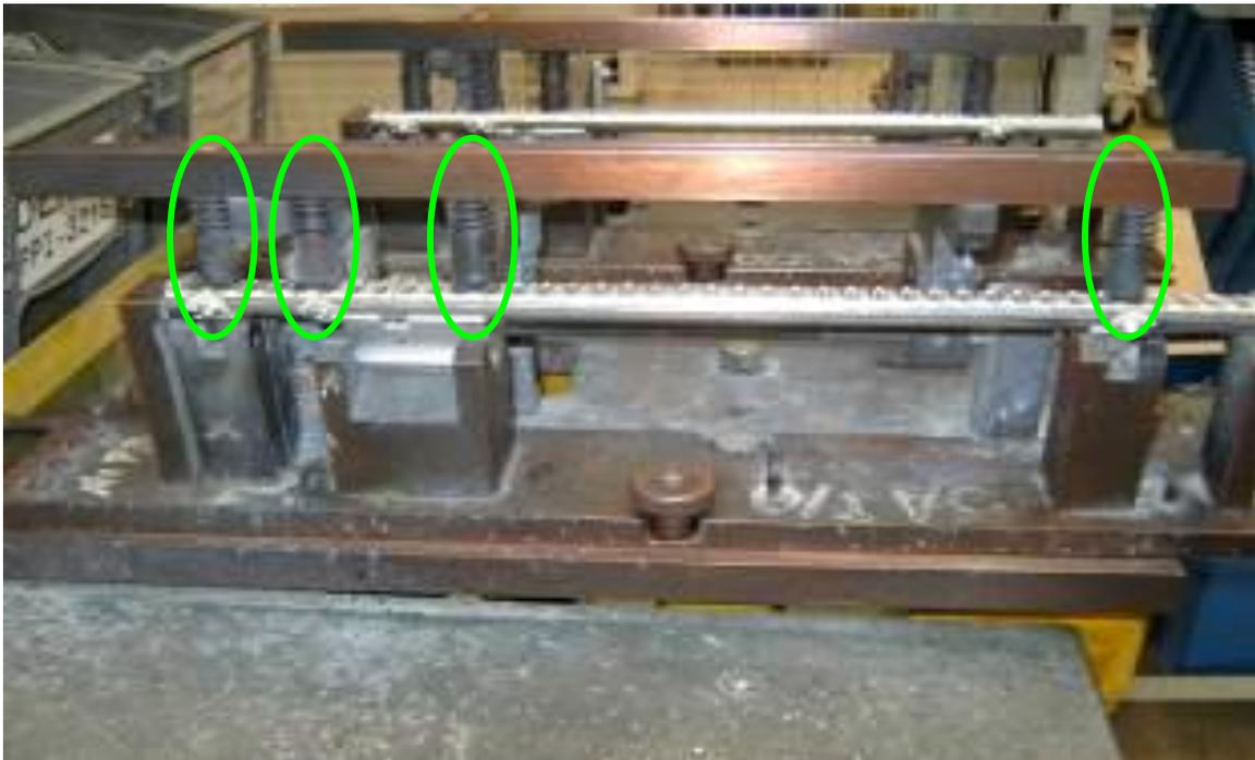
Figura 66: Correcta disposición de guías de esfuerzo en base de soldadura MIG.
