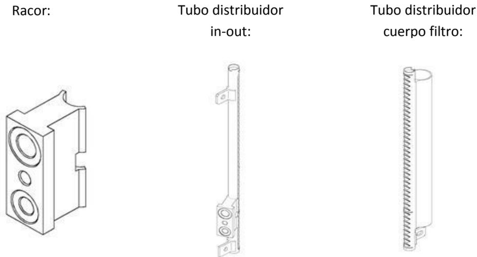
Figura 36: Vistas isométricas de racor – tubo distribuidor in-out – tubo distribuidor cuerpo filtro. Fuente: Denso Manufacturing Argentina S.A.
