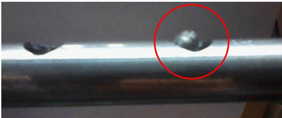
Figura 48: Tubo distribuidor con rebaba metálica en estación de soldadura MIG.
