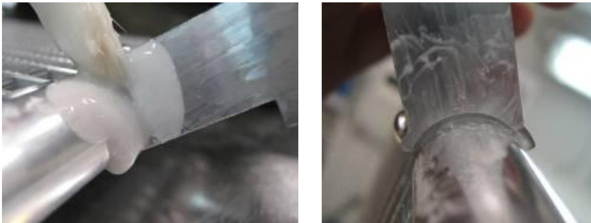
Figura 44: Tapón de NOCOLOK consecuencia de la incorrecta utilización.
