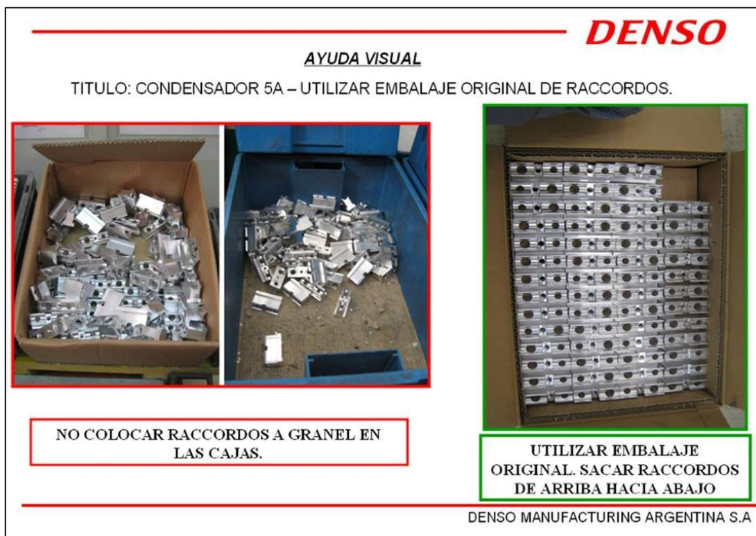
Figura 70: Ayuda visual: Disposición de racores en línea de producción en embalaje original.
