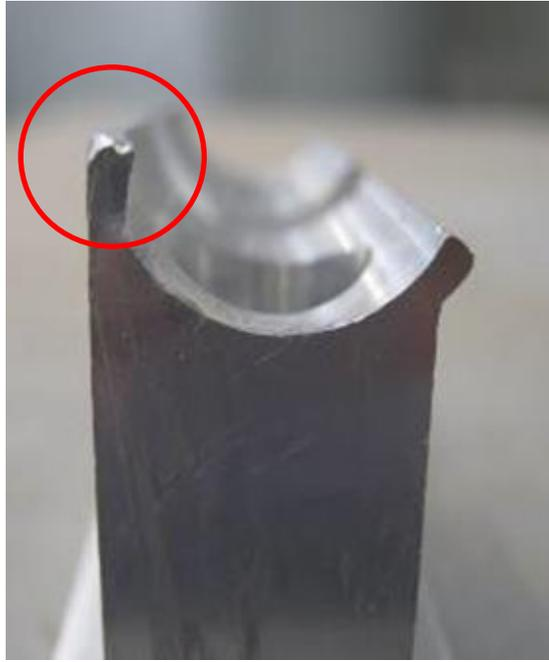
Figura 47: Racor golpeado en estación de soldadura MIG.
