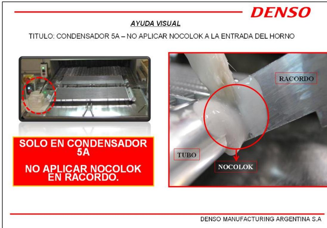
Figura 68: Ayuda visual: Condensador 5A, no aplicar NOCOLOK en racor a la entrada del horno CAB.
