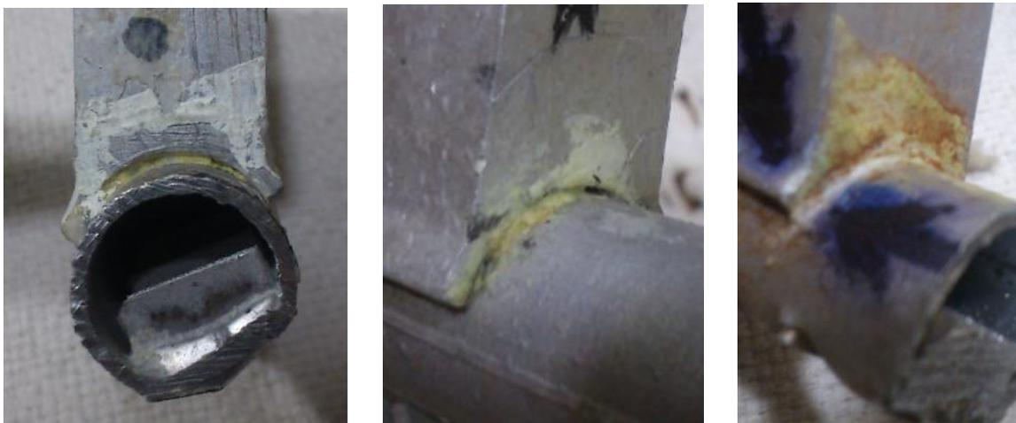
Figura 43: Presencia excesiva de NOCOLOK en zona donde ocurre la fuga.
