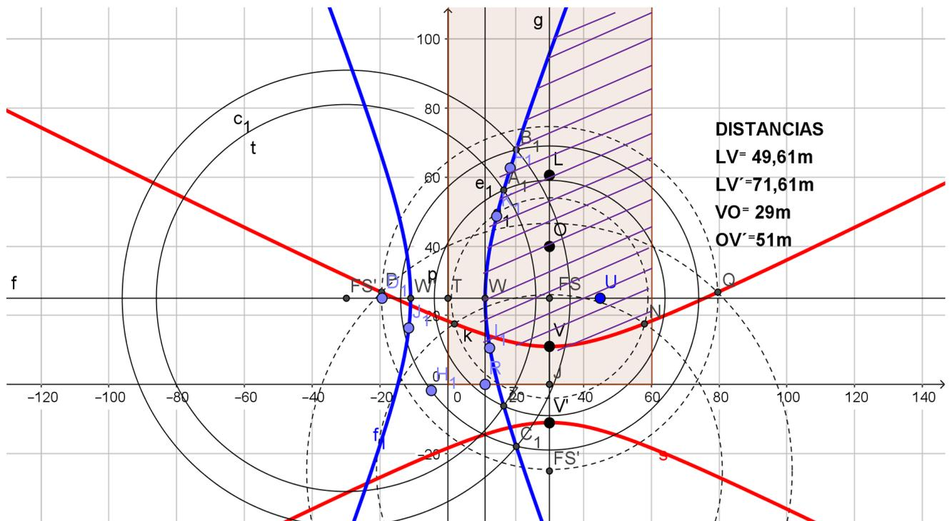
En la imagen inferior, el rectángulo definido como DCFED determina el local (parcialmente a los fines prácticos) representado en una sección vertical o corte. La superficie resaltada indica el área de posible formación de ecos según la posición de la fuente sonora considerada en este caso (un orador).
