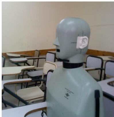
Figura 8: Simulador de cabeza y torso utilizado en la medición de RIR binaural.
