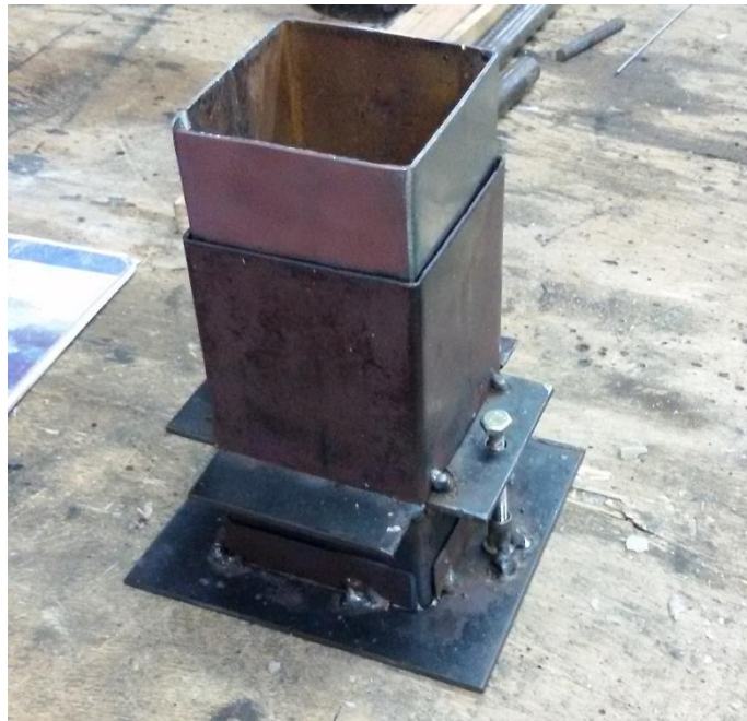
Figura 19.- Molde para probetas cuadradas.
