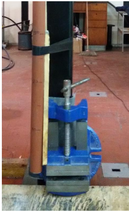
Figura 37.- Dispositivo utilizado para el ensayo de impacto.
