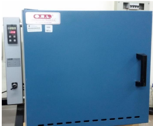
Figura 21.- Horno eléctrico tipo Mufla utilizado.
