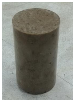
Figura 32.- Probeta cilíndrica relación 2:1.
