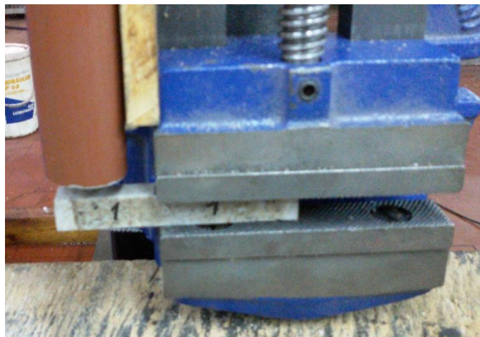
Figura 38.- Fijación de la probeta de impacto.
