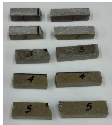
Figura 49.- Probetas de PET con VIDRIO ensayadas.
