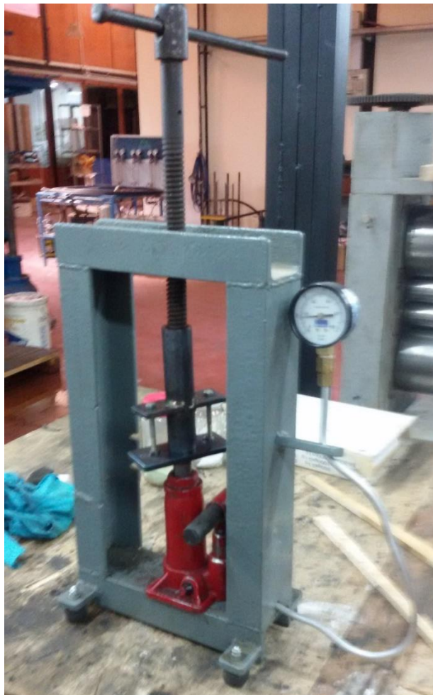
Figura 22.- Prensa hidráulica uniaxial utilizada.
