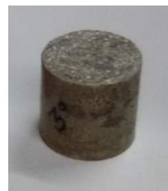
Figura 33.- Probeta cilíndrica relación 1:1.
