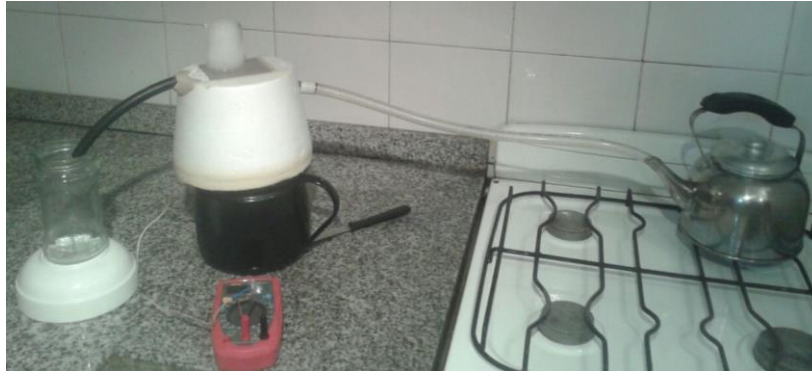
Figura 31.- Dispositivo utilizado para el ensayo de conductividad térmica.
