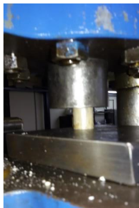
Figura 35.- Probeta a ensayar bajo compresión.
