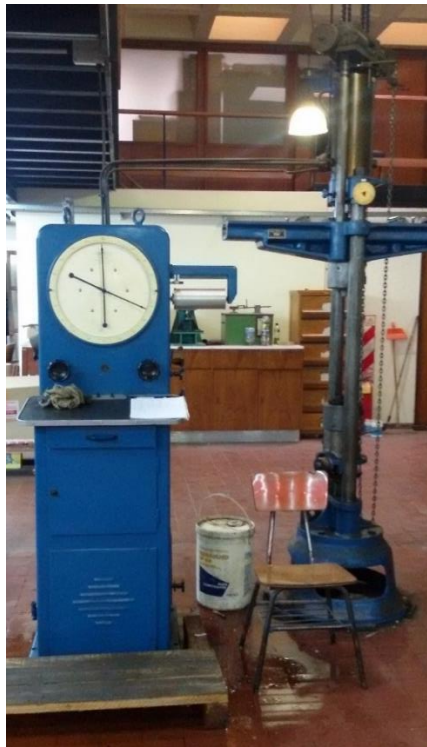
Figura 34.- Maquina de utilizada para el ensayo de compresión.
