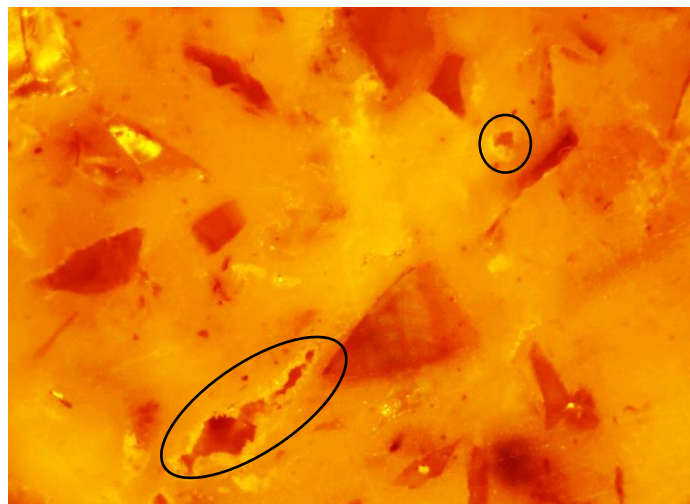
Figura 40.- Muestra de PET con VIDRIO aumentada x40. Las cavidades se encuentran encerradas.
