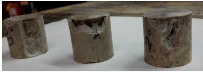
Figura 42.- Probetas de PET. La de la izquierda descascaró, las otras presentan bóvedas de aire.
