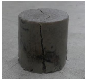
Figura 44.- Probeta de PET con VIDRIO. Pone en evidencia la falla por planos.
