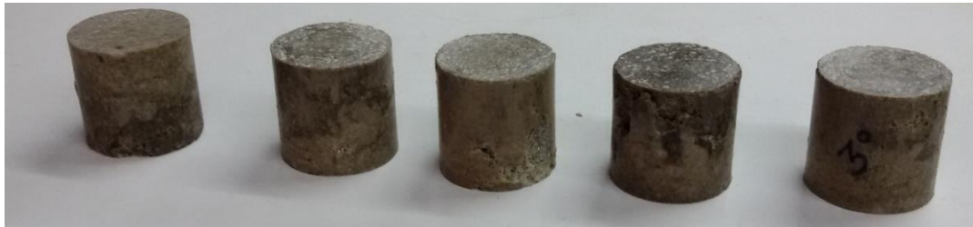
Figura 43.- Probetas de PET con VIDRIO. Falla tipo barril, por planos.
