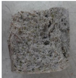
Figura 45.- Probeta de PET con VIDRIO. Uno de los planos separados de la fisura ocasionada en el ensayo.
