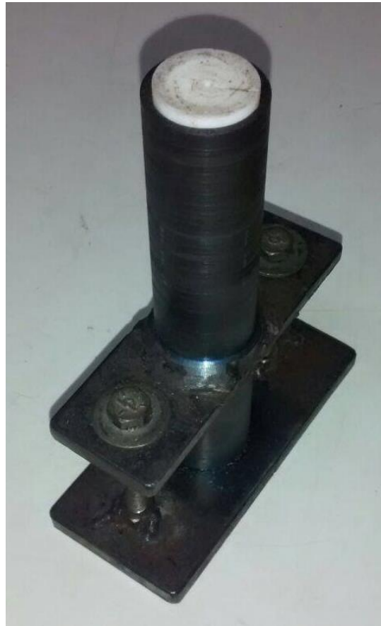
Figura 18.- Molde de acero para probetas cilíndricas.
