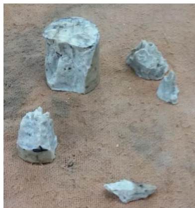
Figura 41.- Probetas de PET con falla frágil.
