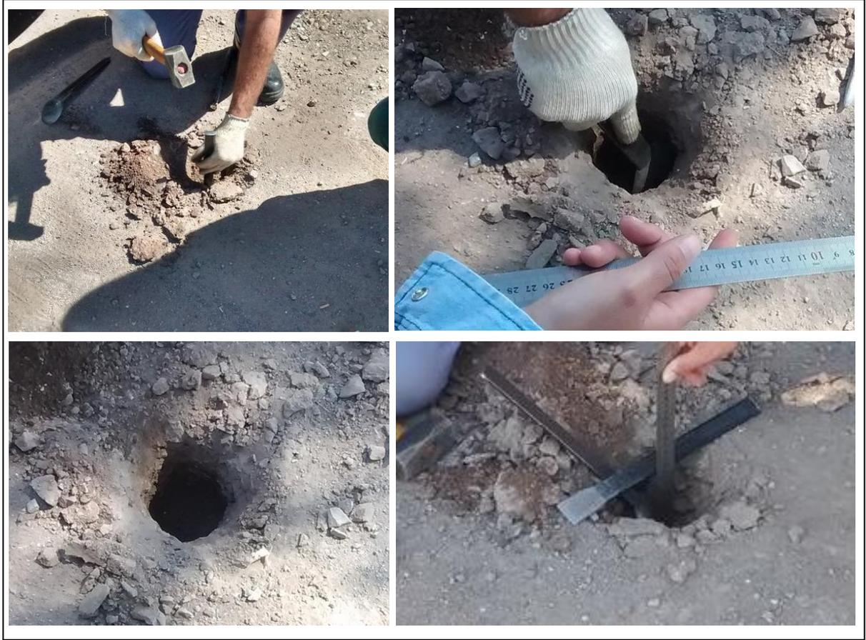
**Figura 4 - 1 . Extracción de muestras de base granular y control de espesor.**
