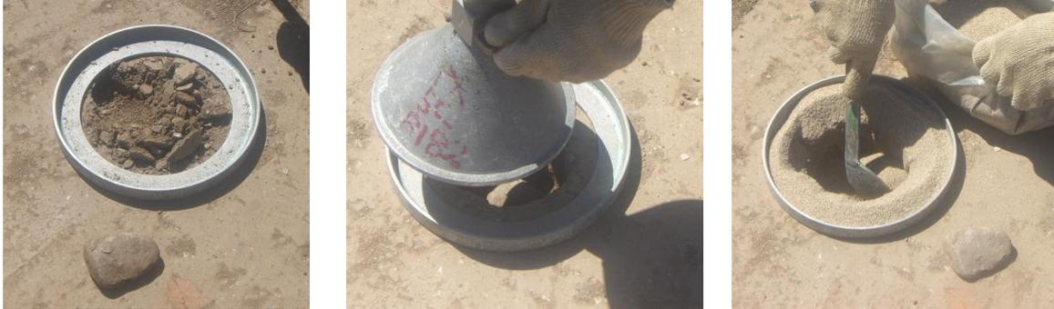
Por último se tomó una muestra de suelo para realizar el ensayo PROCTOR, para tener referencia de la curva de densidades correspondiente al material con el que se estaba trabajando.
