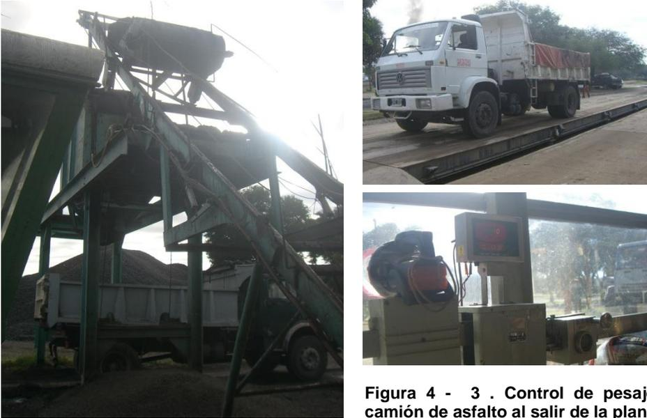
Figura 4 - 3 . Control de pesaje del camión de asfalto al salir de la planta.
