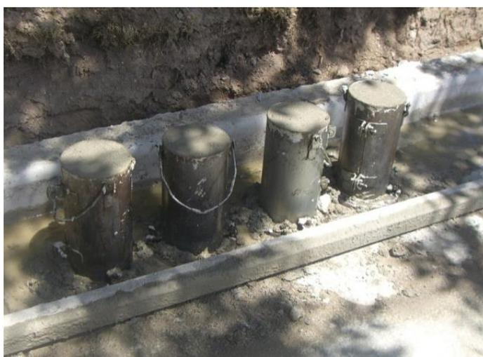
**Figura 3 - 36. Probetas de Hormigón para ensayar a Compresión.**
