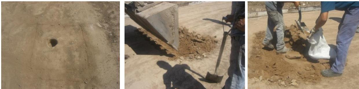
**Figura 3 - 26. Procedimiento para toma de muestras para realizar ensayos de densidad de cono de arena y Proctor.**
