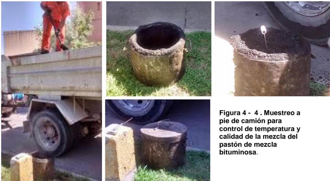
Figura 4 - 4 . Muestreo a pie de camión para control de temperatura y calidad de la mezcla del pastón de mezcla bituminosa.
