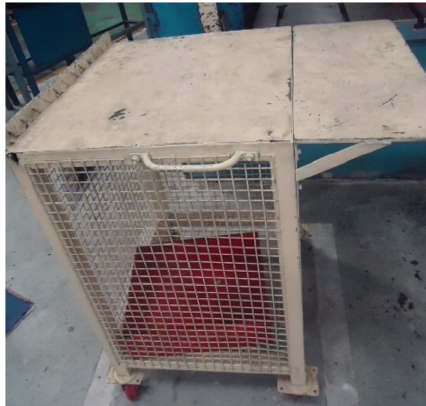
Fotografías 4.8: Muestra la mesa de materia prima y la mesa de trabajo luego de la colocación de ruedas para facilitar su desplazamiento en el puesto de trabajo.
