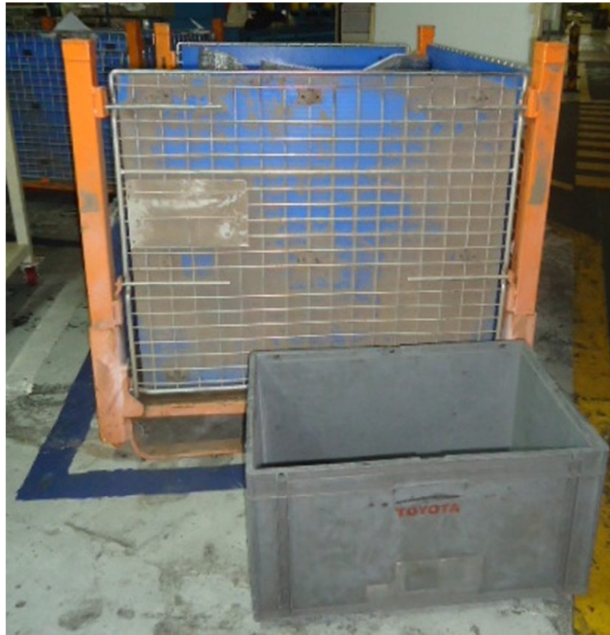
Fotografías 4.5: Muestra la caseta del cliente que reemplaza a los grandes Racks que se utilizaban en la situación inicial.
