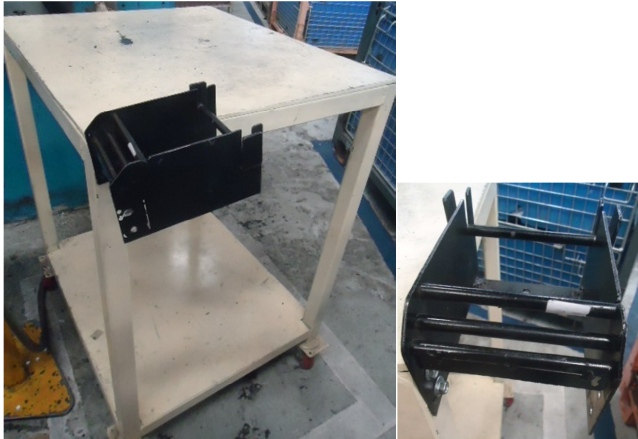
Fotografías 4.7: Muestra el dispositivo realizado para la colocación del rollo de etiquetas autoadhesivas
