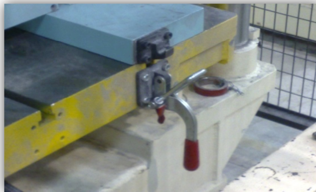
Figura 3.17: Fotografía de clamps de ajuste rápido. Fuente: Planta Autoneum en Turquía (Junio, 2013)
