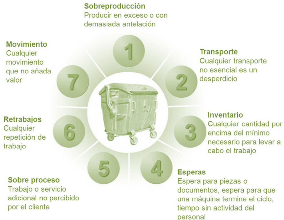
Figura 2.4: Esquema de los 7 residuos según Taiichi Ohno. Fuente: http://blog.iedge.eu/ , José Manuel Yagüe, 2014.
