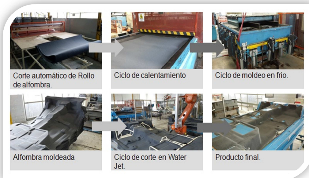
Figura 1.13: Proceso de una alfombra para la camioneta Ranger en la célula de insonorizantes.
