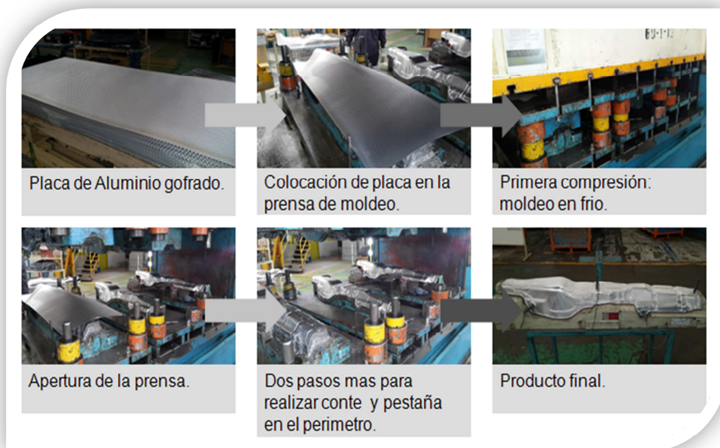
Figura 1.11: Proceso de un escudo térmico en la célula de aluminio.
