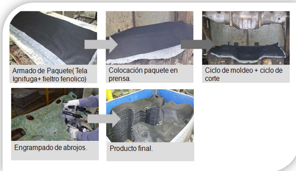
Figura 1.12: Proceso de un insonorizante (DashOuter) para la camioneta Ranger en la célula de insonorizantes.
