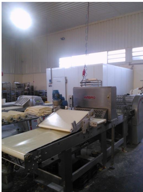
Figura 3.5: Cortadora circular Ambro modelo MM. N° serie 415
