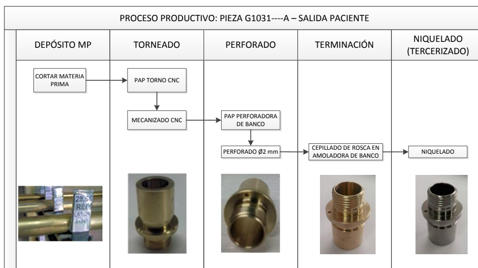
Figura 1.7 Diagrama de flujo de la pieza G1031----A.
