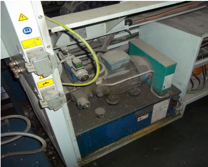
Figura 7.4 Central hidráulica y motor principal sin mantenimiento del torno CNC G240
