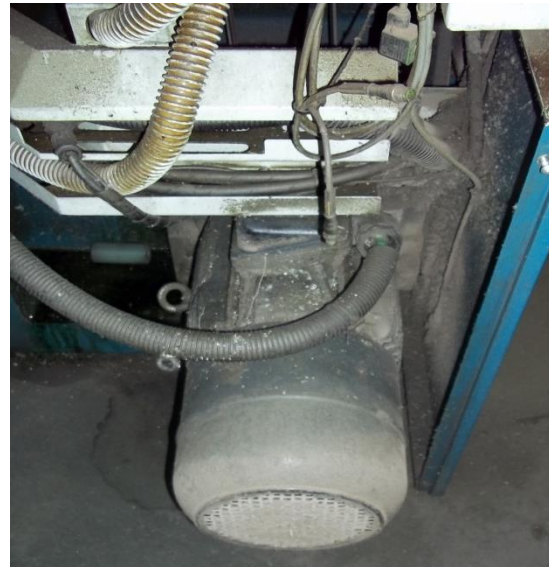
Figura 7.4 Central hidráulica y motor principal sin mantenimiento del torno CNC G240
